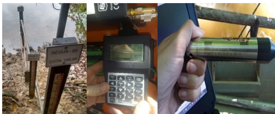
Figura 26 – Réguas limnimétricas instaladas nas seções, leitor do data logger das estações que mostra o nível do rio e outras variáveis, e a sonda de nível HOBO.
